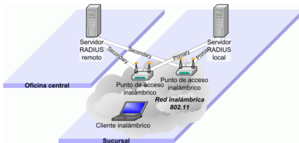
Figura 5.4 Estrategia de conmutación por error y equilibrio de carga basada en puntos de acceso inalámbricos con servidores RADIUS locales y remotos
