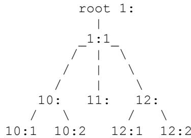
Cuando encolamos un paquete, se consulta la cadena de filtros para cada rama para que de las instrucciones relevantes. Una configuración típica podría tener un filtro en 1:1 que dirija un paquete a 12:, y uno en 12: que envíe el paquete a 12:2.
