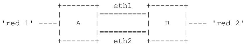
A y B son routers, y por el momento asumiremos que ambos funcionan con Linux. Si el tráfico va de la red 1 a la red 2, el router A necesita distribuir los paquetes sobre ambos enlaces hacia B. Se necesita configurar el router B para que acepte esto. Lo mismo sucede en la otra dirección: cuando los paquetes van desde la red 2 a la red 1, el router B necesita enviar paquetes tanto sobre eth1 como eth2.
