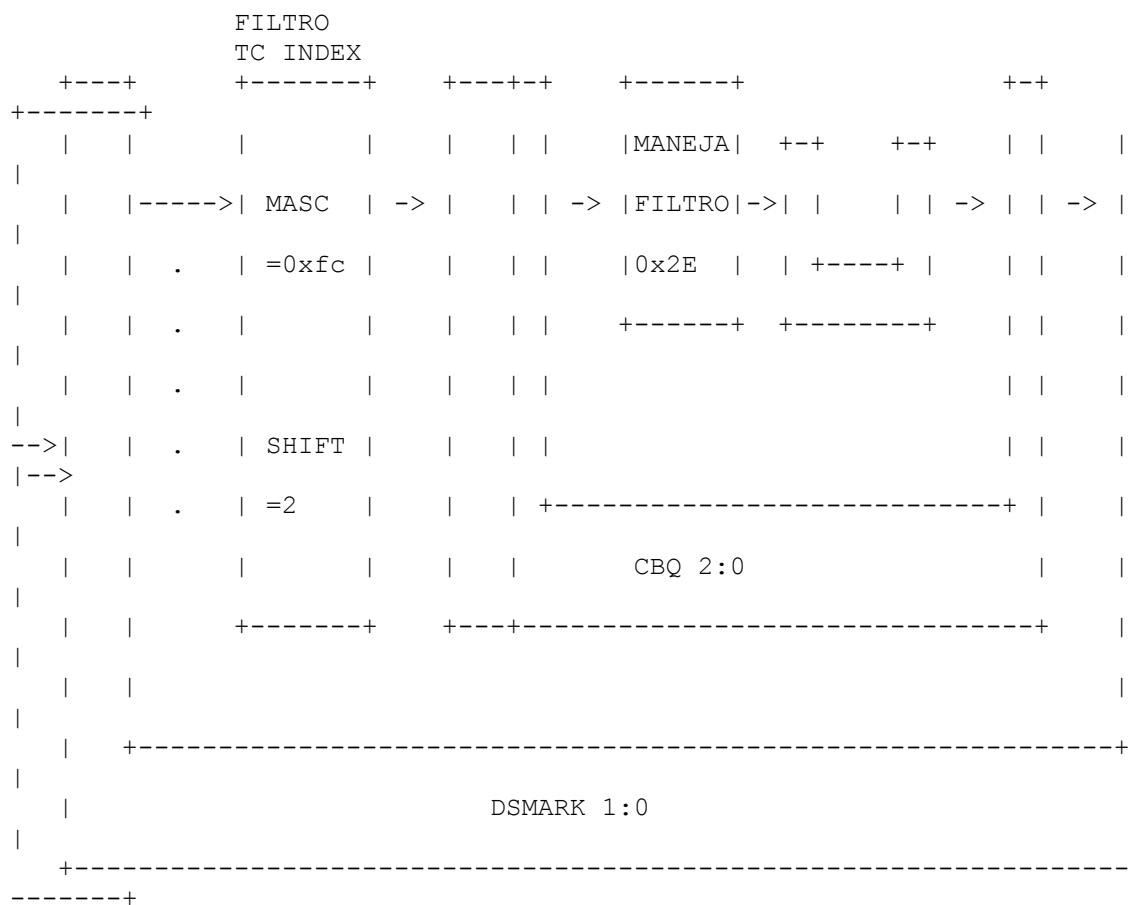
Entonces llega el paquete con el valor del campo DS puesto a 0xb8. Como explicamos anteriormente, la qdisc dsmark identificada por el id 1:0 en el ejemplo toma el campo DS y lo almacena en la variable `skb->tc_index`. El siguiente paso del ejemplo corresponde al filtro asociado con esta qdisc (segunda línea del ejemplo). Esto realizará las siguientes operaciones:
